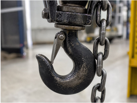
État du crochet de levage et de son linguet de sécurité photo-linguet.jpg
